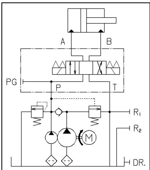
図1に示す様に低圧大容量と高圧小容量の2台のポンプ、リリーフ弁、アンロード弁が内蔵されています。オプションで電磁切換弁、積層弁の取付けができます。
